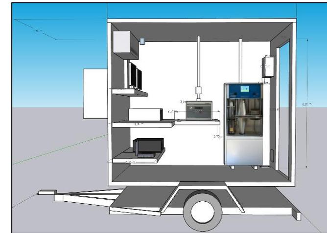
Schéma d'une remorque avec matériels informatiques et analyseurs
